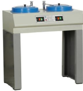
PG-2C 金相试样抛光机是对 PG-2 金相试样抛光机的不完善处进行针对性的设计改进，该机除保持原 PG-2 的抛盘直径与传动功率均大于国内同类产品外，结合广大使用人员的建议和要求，增加了在抛光时作稀释冷却用的供水系统和易清污的抽屉式积污匣，并该机的外形更新颖美观，对设备的使用和保养也更为方便。
